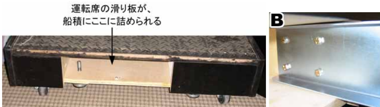
図3. 運転席滑り板の取り付け
